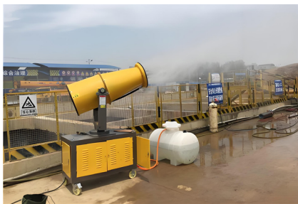
图 8-1 雾炮设备示意图
