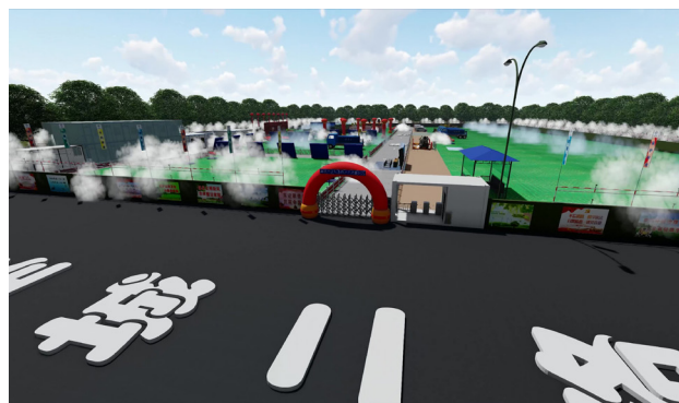
图 2-20 工地围墙喷淋系统示意图
